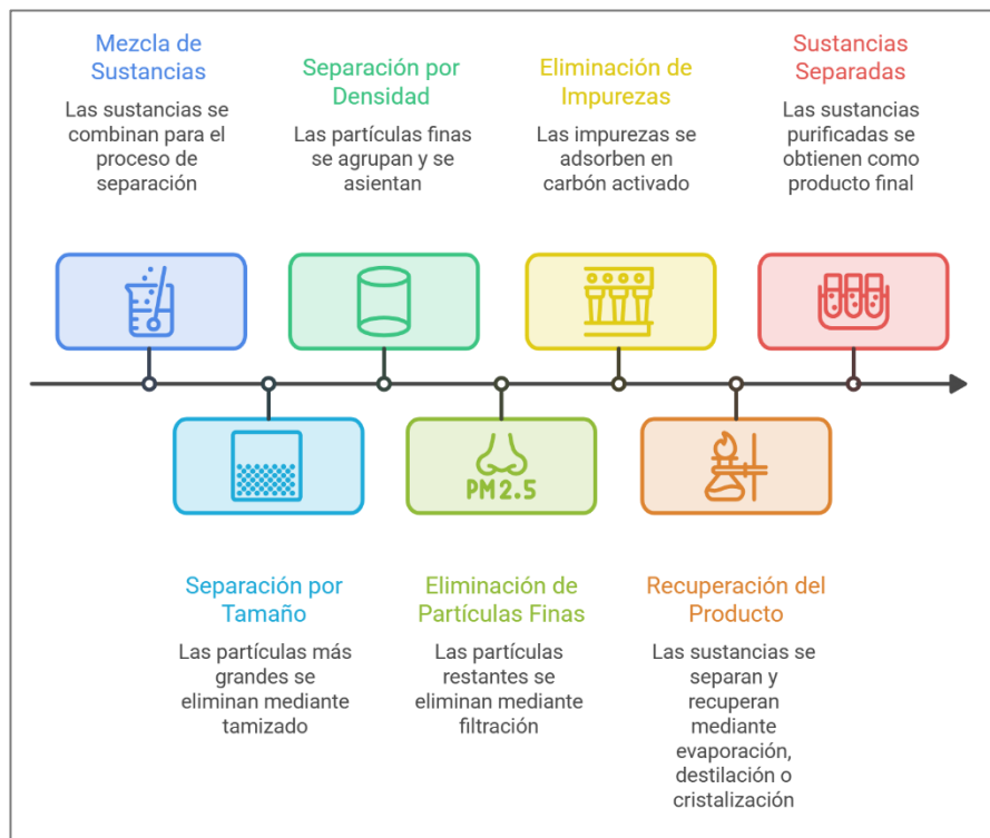
Figura 8. Secuencia combinada para la separación y recuperación de sustancias
