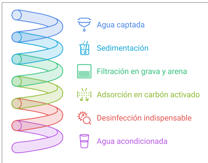
Figura 16. Integración de procedimientos para el acondicionamiento del agua
